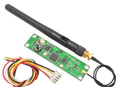
Rysunek 57. Moduł radiowy DMX512 znany z portalu aukcyjnego, który można zamontować w środku obudowy bramki "PROMYK 3.60" lub na zewnątrz używając specjalnych otworów na opaski zaciskowe.
