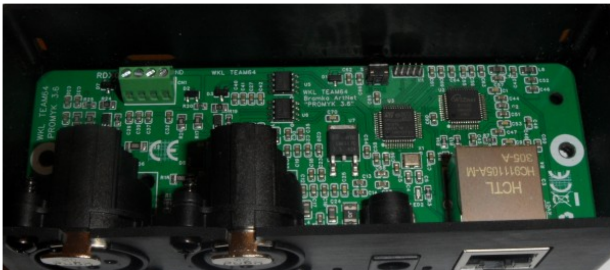
Rysunek 55. Gniazda śrubowe RDX0 służy do podłączenia modułów radiowych DMX512 bez potrzeby lutowania i otwierania obudowy. Dostęp do śrub oraz przewodów jest umożliwiony przez specjalne otwory w obudowie
