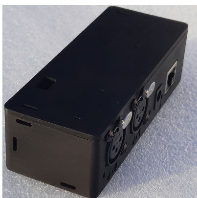
Rysunek 56. Lewy bok obudowy z otworem górnym do dostępu dla śrub złącza RDMX0
