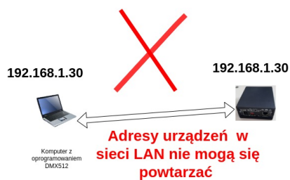
Rysunek 21. Często błędem jest ustawienie tego samego adresu IP dla karty sieciowej komputera co w bramce "PROMYK 3.50"
