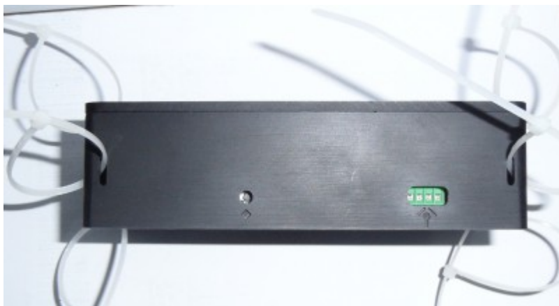
Rysunek 6. Mocowanie do obiektów stałych za pomocą opasek lub rzepów przewleczonych przez otwory w obudowie
