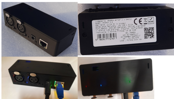
Rysunek 1. Wygląd urządzenia: Bramka ART-NET DMX512 "PROMYK 3.60"
