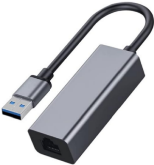
Rysunek 8. Karta sieciowa LAN na USB. Taka karta wprowadza dla złącza USB całkowitą separację galwaniczną, gdyż zawiera transformator sygnałowy.
