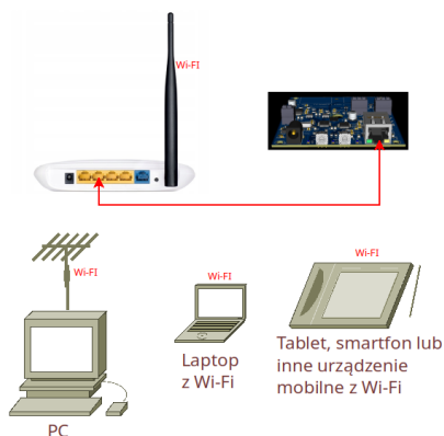
Rysunek 26. Typowe zastosowanie połączenia bezprzewodowego z bramką "PROMYK 3.50"
